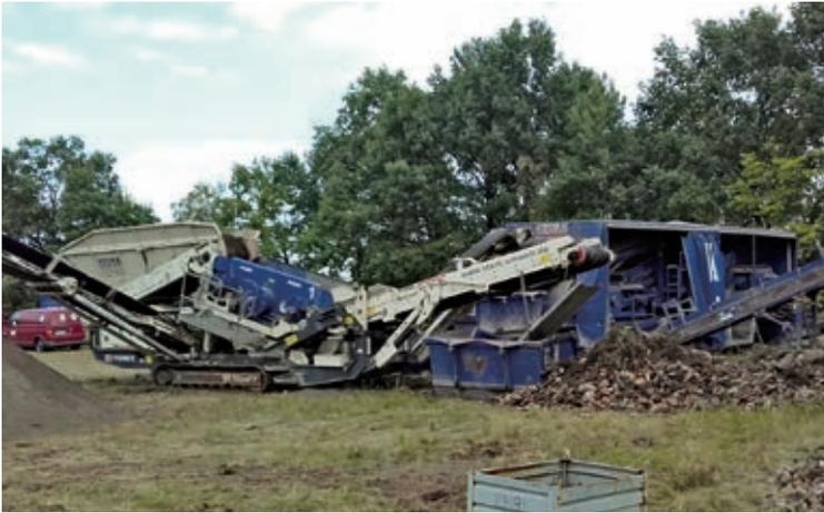
**Räummaßnahme in Rehagen mittels einer Siebanlage, mit der Kleinmunition aus dem Erdreich separiert wird**
