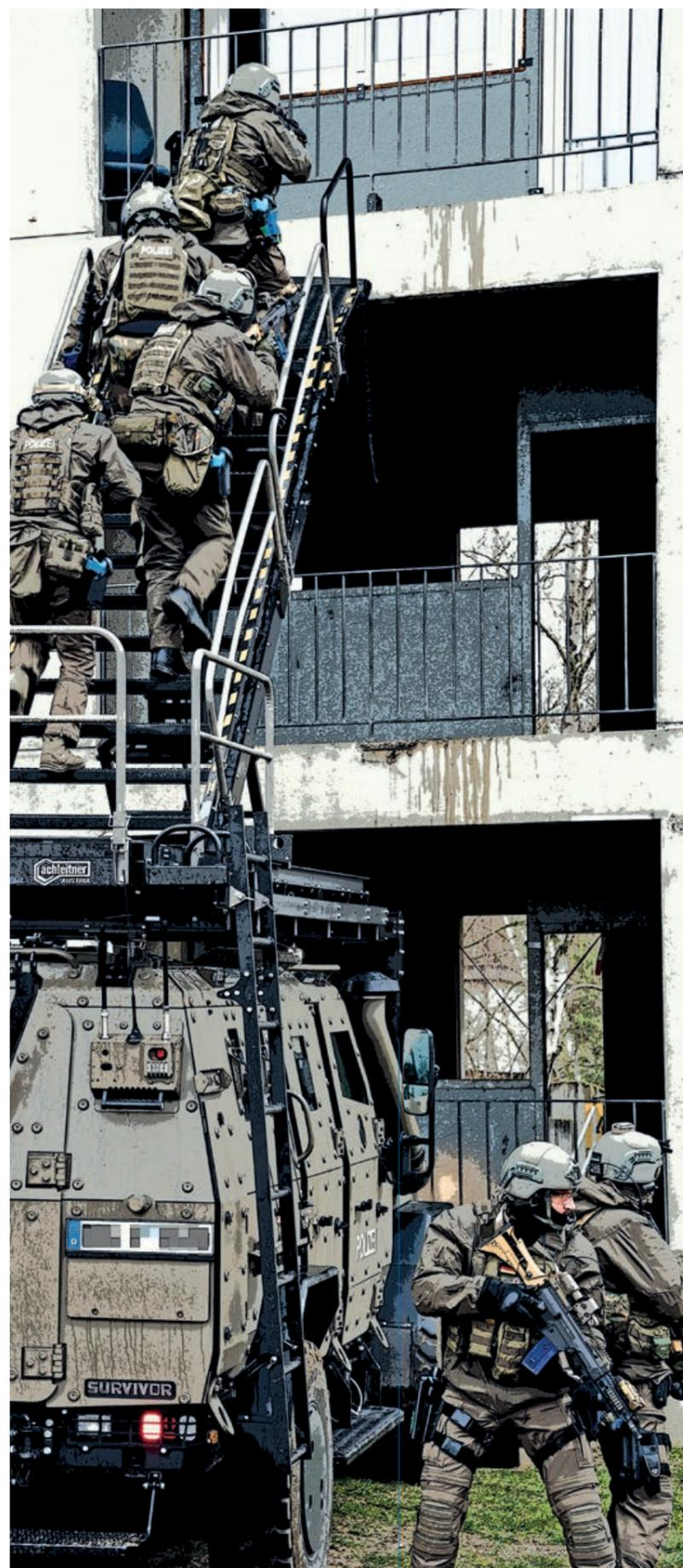
Der HMV Survivor besitzt einen Leiteraufbau, mit dem die Spezialeinheiten auch in obere Stockwerke eindringen können.
