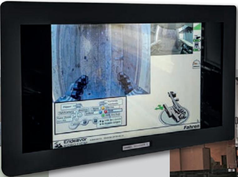
**KOBRA Operator:** Bilder der Greiferkamera und einer der vorderen Fahrkameras Kobra aus der Sicht des Operators am Bildschirm im Einsatzfahrzeug – dieser befindet sich in einer sicheren Entfernung zum Gefahrenbereich
